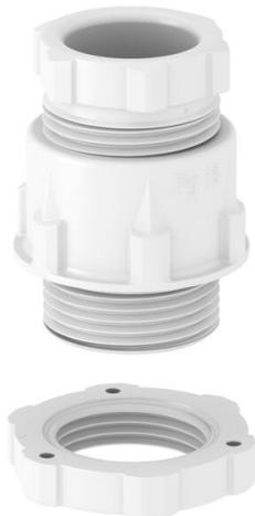
Стандартный кабельный ввод, форма А согласно DIN 46320, с простым уплотнительным кольцом из NR/SBR соединительная резьба Pg согласно DIN 40430 класс защиты: IP 65 с уплотнительным кольцом и соединительной резьбой, IP 54 без уплотнительного кольца и соединительной резьбы.
