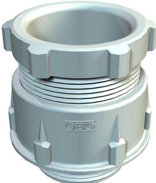
Стандартный кабельный ввод, формы А, согласно DIN 46320, с обычным уплотнительным кольцом из NR/SBR с метрической соединительной резьбой согласно IEC 423.
