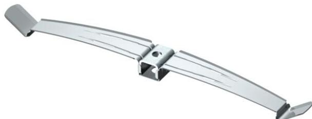
Кабельный зажим из металла для компактного монтажа высокой механической прочности, в том числе в случае пожара. Применяется для монтажа в качестве специальной конструкции при прокладке кабельных трасс повышенной живучести в соответствии с DIN 4102 часть 12. Возможно применение распорки 2033 D 15x3 G (заказывается отдельно) для увеличения монтажной высоты с 10 мм до 13 мм. Кабельный зажим подходит для монтажа над подвесными противопожарными потолками в соответствии с DIN 4102.
