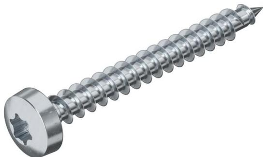
Закаленная сталь с гальванической оцинковкой и хостефлоновым покрытием. Плоскоконическая головка с Т-образной насадкой (звездообразное углубление), разм. Ø 3 мм T10, Ø 3,5 мм T15, Ø 4 и 4,5 мм T20, Ø 5 мм T25.
