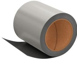
Огнестойкий бандаж, покрытый с одной стороны веществом, которое в случае пожара образует пену. Предназначен для изоляции в кабельных проходках с использованием сухого раствора PYROMIX® и огнестойкой мягкой перегородки PYROPLATE® Fibre. На ткань-подложку нанесен с одной стороны слой вспучивающейся огнестойкой краски. Номинальная толщина 1,5 мм.
