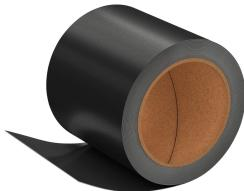
Огнестойкий бандаж, покрытый с обеих сторон веществом, которое в случае пожара образует пену. Предназначен для изоляции в кабельных проходках с использованием сухого раствора PYROMIX® и огнестойкой мягкой перегородки PYROPLATE® Fibre. На ткань-подложку нанесен с обеих сторон слой вспучивающейся огнестойкой краски. Номинальная толщина 1,5 мм.
