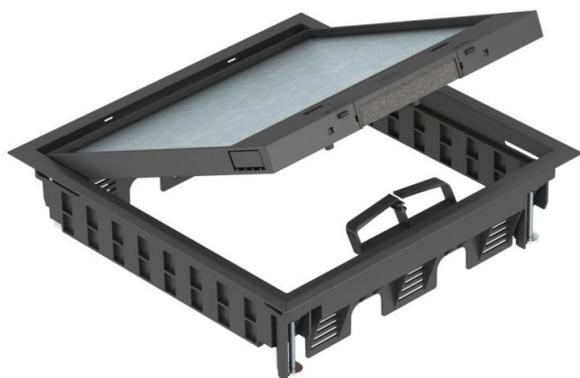
Резервуар прибора с фиксирующим ползунком для макс. 12 отдельных приборов серии Modul 45 в 3 универсальных кронштейнах UT4, применение в системах каналов и системных полах во внутренних помещениях. Выемка 5 мм в откидной крышке для фрагмента напольного покрытия при необходимости увеличивается до 10 мм.
