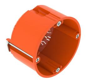
Монтажная коробка для установки в полую стену на глубину не менее 47 мм и с толщиной пластины 5-40 мм.
