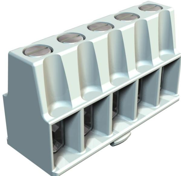
Клеммная колодка и болты из стали, оцинкованной способом и прозрачным пассивированием, номинальное сечение 1,5 ÷ 6 мм<sup>2</sup>, номинальное напряжение 400 В, 5-контактов, с разъемами, макс. размеры подключаемых сечений для каждой клеммы: 3 x 6 мм<sup>2</sup>, 4 x 4 мм<sup>2</sup> или 6 x 2,5 мм<sup>2</sup>.
