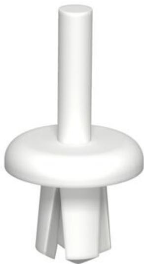
Для быстрого монтажа и достижения оптимального уровня функциональности следует использовать клепальный инструмент KNW1. Размер просверленного отверстия: 4,5 мм.
