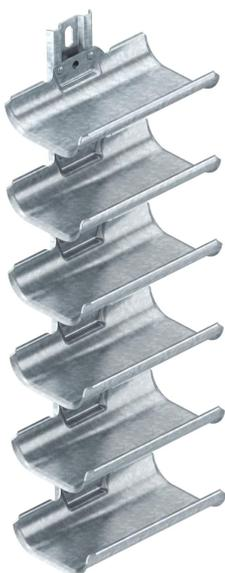
Кабельный лоток для быстрой и простой прокладки кабеля в местах, где стандартная система кабельных лотков не может быть применена из-за нехватки места. Кабельный лоток имеет большую площадь и закругленный внешний кант для защиты кабеля. В соответствии со стандартом DIN VDE 0298-300 расстояние между опорами не должно превышать 0,8 м.
