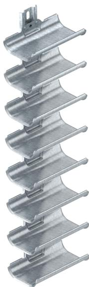
Кабельный лоток для быстрой и простой прокладки кабеля в местах, где стандартная система кабельных лотков не может быть применена из-за нехватки места. Кабельный лоток имеет большую площадь и закругленный внешний кант для защиты кабеля. В соответствии со стандартом DIN VDE 0298-300 расстояние между опорами не должно превышать 0,8 м.
