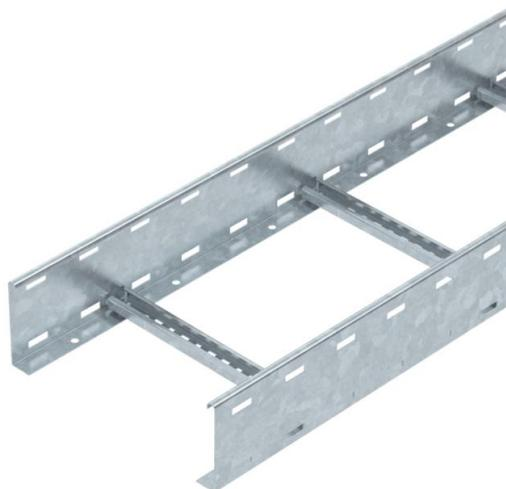
Кабельный лоток с высотой боковой стенки 110 мм с приваренными перекладинами и профилем С30, открываемым вверх. Загнутая боковая стенка для усиления конструкции и защиты кромок. Крепление на кронштейн производится с помощью фиксаторов типа LKS 40. Размер шлица в поперечине составляет 16,5 мм, подходящий тип зажимной скобы 2056.
