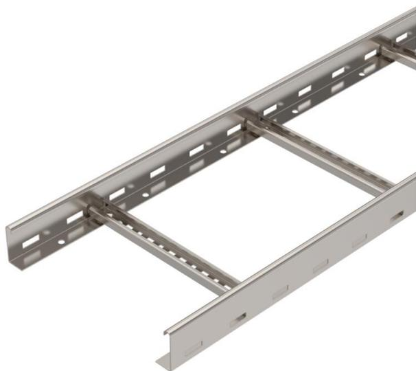
Кабельный лоток с высотой боковой стенки 60 мм с приваренными перекладинами и профилем С30, открываемым вверх. Загнутая боковая стенка для усиления конструкции и защиты кромок. Крепление на кронштейн производится с помощью фиксаторов типа LKS 40. Размер шлица в поперечине составляет 16,5 мм, подходящий тип зажимной скобы 2056.
