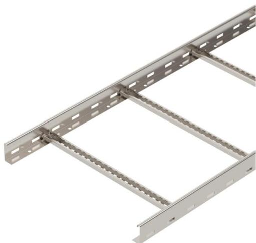
Kabelleiter in Seitenhöhe 60 mm mit eingeschweißten, nach oben offenen C30-Profil Sprossen. Загнутая боковая стенка для усиления конструкции и защиты кромок. Крепление на кронштейн производится с помощью фиксаторов типа LKS 40. Размер шлица в поперечине составляет 16,5 мм, подходящий тип зажимной скобы 2056. Магнитное затухание от влияния экрана: без крышки 10 дБ, с крышкой 15 дБ.
