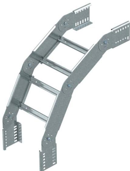
Вертикальный регулируемый угол 90° для всех типов кабельных лотков лестничного типа с высотой боковой стенки 110 мм. Фасонная деталь поставляется в разобранном состоянии вместе с шарнирными соединителями и необходимым количеством болтов.
