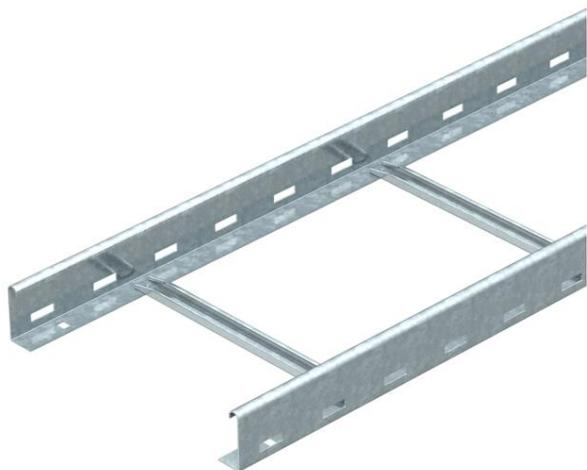
Кабельный лоток лестничного типа с перфорированными боковыми стенками высотой 60 мм, с перекладиной NS. Кабельные лотки лестничного типа поставляются в сложенном виде. Подробную информацию о зажимных скобах 2056 смотрите в разделе "Системы вертикальных кабельных лотков лестничного типа".
