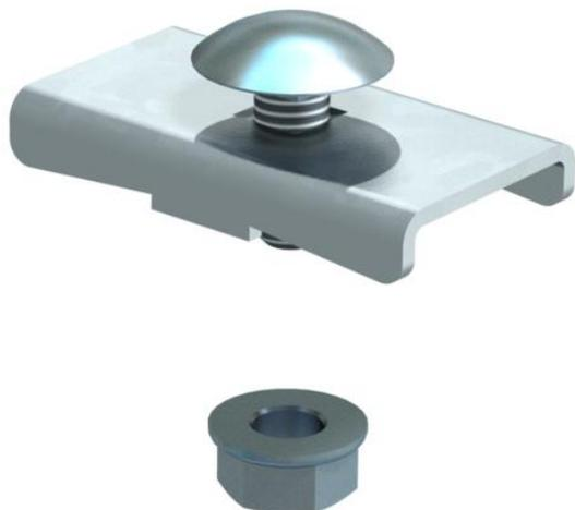
Фиксатор для крепления кабельных лотков лестничного типа с высотой боковой стенки 45 и 60 мм, к настенному/опорному кронштейну. Крепление на кронштейнах MWA 12, AW 15, AW 30 и AW 55 с помощью болта FRSB M6x20, поставляемого в комплекте. Включает болты с полукруглыми плоскими головками и комбинированные гайки.
