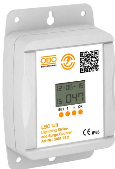
Счетчик ударов молнии LSC I+II регистрирует импульсные токи и сохраняет их с указанием времени и даты. Благодаря этому обеспечивается постоянный контроль, позволяющий зафиксировать удар молнии в систему молниезащиты. В таком случае согласно стандарту VDE 0185-305 (ГОСТ Р МЭК 62305) необходимо произвести над системой молниезащиты профилактический ремонт.
