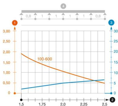
Диаграмма нагрузки на кабельный лоток типа MKSMU 85
