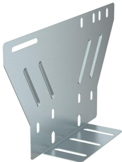
Универсальная монтажная пластина для крепления FireBox серии Т к обратной стороне кабельных, проволочных и кабельных лестничных лотков с максимальной высотой стороны 60 мм. Позволяет прокладывать огнестойкий кабель без необходимости сгибать его над боковой стенкой лотка. Подходит для всех огнестойких коробов FireBox.
