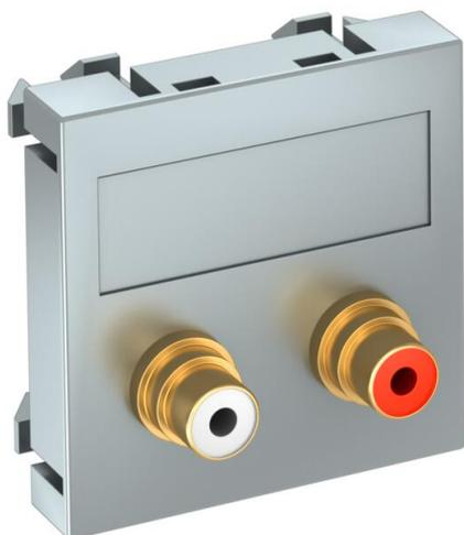
Корпус с двумя разъемами «тюльпан» для Audio R/L, прямой кабельный вывод, с полем для надписи, два гнезда «тюльпан» (RCA) с подключением пайкой, цветовая кодировка красный/белый. Суппорт с растровым креплением подходит для горизонтального и вертикального монтажа.
