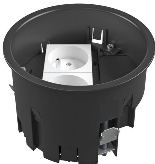
Монтажная коробка для лючка GES R2, для установки в монтажном основании UD GES R2 и в двойных полах с монтажным отверстием диаметром 122 мм.
