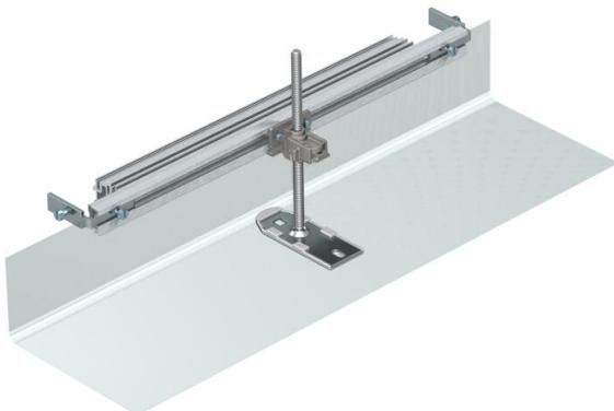
Торцевая заглушка канала: состоит из гибкой перегородки с боковыми профилями и профилями длястыковки с напольным покрытием. В комплект поставки входит уголок для соединения каналов и регулируемый по высоте крепежный уголок.
