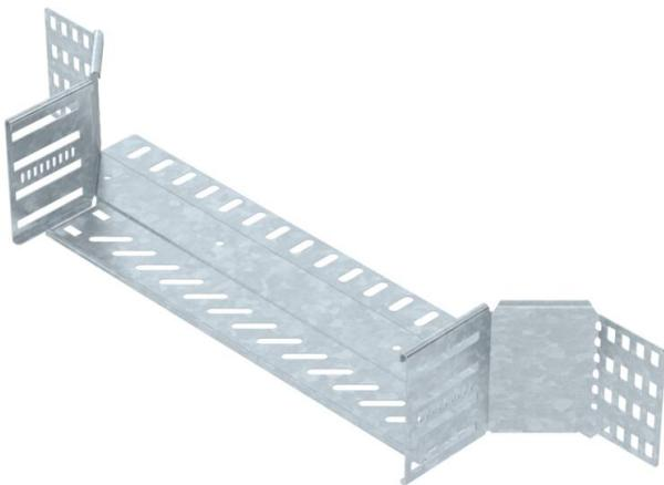
Т-образное/крестовое соединение для создания горизонтального или крестообразного ответвления, фасонная деталь для защелкиваемых и привинчиваемых кабельных лотков, высота боковой стенки 110 мм. Безвинтовой монтаж с помощью двойных зажимов или резьбовое соединение посредством винтов с полукруглой низкой головкой FRS и комбинированных гаек M6. Можно устанавливать как внутри помещения, так и снаружи. Крепежный материал заказывается отдельно.
