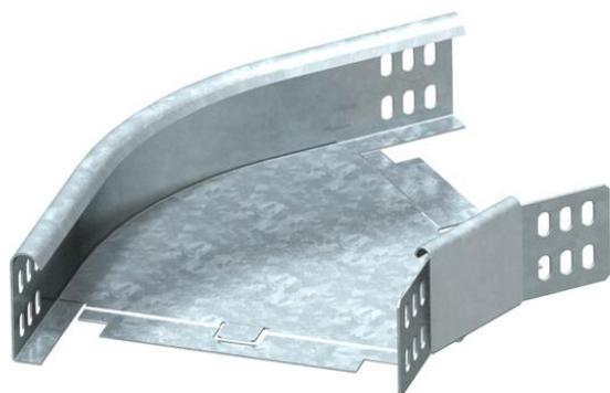
Горизонтальная угловая секция 45° для всех типов кабельных лотков, высота боковой стенки которых составляет 60 мм. Фасонная деталь поставляется в разобранном состоянии. Угловой соединитель WKV 60 предназначен для секций 90°, и его адаптируют к 45° в месте установки. В комплекте с соответствующими крепежными элементами.
