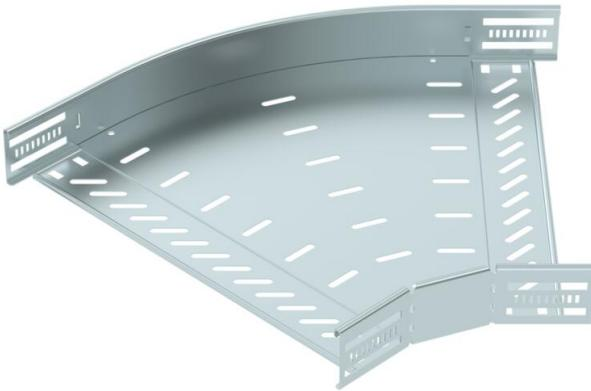
Угловая секция 45° для создания горизонтального ответвления, фасонная деталь для защелкиваемых и привинчивающихся кабельных лотков, высота боковой стенки 60 мм. Безвинтовой монтаж с помощью двойных зажимов или резьбовое соединение посредством винтов с полукруглой низкой головкой FRS и комбинированных гаек M6. Можно использовать в помещении. Крепежный материал заказывается отдельно.
