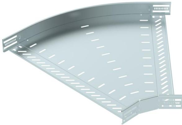
Угловая секция 45° для создания горизонтального ответвления, фасонная деталь для защелкиваемых и привинчивающихся кабельных лотков, высота боковой стенки 60 мм. Безвинтовой монтаж с помощью двойных зажимов или резьбовое соединение посредством винтов с полукруглой низкой головкой FRS и комбинированных гаек M6. Можно использовать в помещении. Крепежный материал заказывается отдельно.
