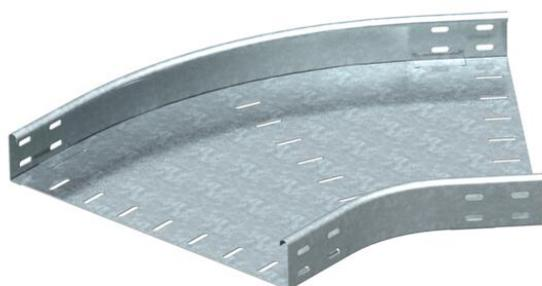
Горизонтальная угловая секция 45° для всех типов кабельных лотков, высота боковой стенки которых составляет 60 мм. Детали для крепления заказываются отдельно.
