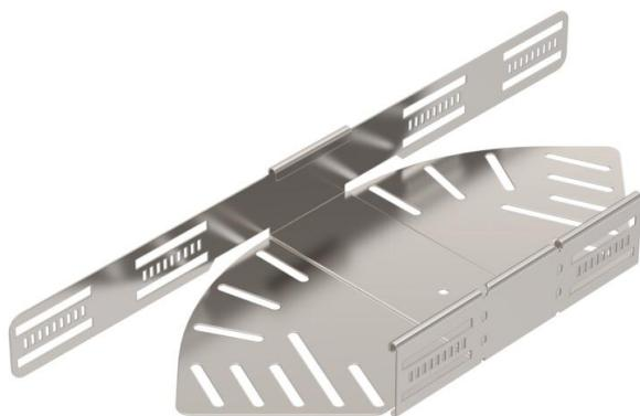
Угловая секция с возможностью регулировки угла для создания горизонтального ответвления, фасонная деталь для защелкиваемых и привинчивающихся кабельных лотков, высота боковой стенки 60 мм. Регулируемый угол 0–90°. Безвинтовой монтаж с помощью двойных зажимов или резьбовое соединение посредством винтов с полукруглой низкой головкой FRS и комбинированных гаек M6. Можно устанавливать как внутри помещения, так и снаружи. Крепежный материал заказывается отдельно.
