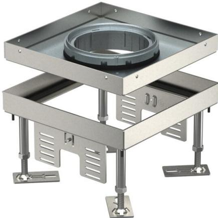
Квадратная кассета для больших нагрузок для трубы, номинального размера 4 для монтажа электроустановочных изделий в системах каналов, двойных и пустотных полах с сухим или влажным типом уборки во внутренних помещениях. Класс нагрузки от 1 до 10 кН.
