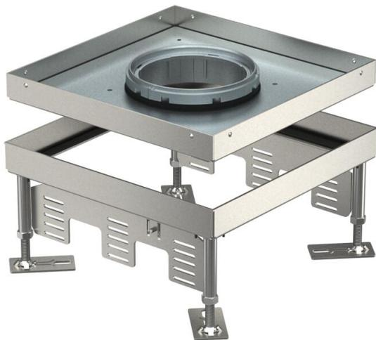
Квадратная кассета для больших нагрузок для трубы, номинального размера 9 для монтажа электроустановочных изделий в системах каналов, двойных и пустотных полах с сухим или влажным типом уборки во внутренних помещениях. Класс нагрузки от 1 до 10кН.
