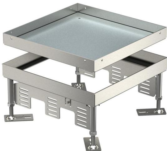
Квадратная кассета для больших нагрузок, глухая, номинального размера 9 для формирования ревизионного отверстия в системах каналов, двойных и пустотных полах с сухим или влажным типом уборки во внутренних помещениях. Класс нагрузки от 1 до 10кН. Подходит только для гладких напольных покрытий.
