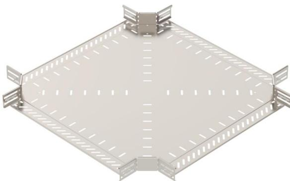
Крестообразное ответвление для создания горизонтального ответвления, фасонная деталь для защелкиваемых и привинчиваемых кабельных лотков, высота боковой стенки 60 мм. Безвинтовой монтаж с помощью двойных зажимов или резьбовое соединение посредством винтов с полукруглой низкой головкой FRS и комбинированных гаек M6. Можно устанавливать как внутри помещения, так и снаружи. Крепежный материал заказывается отдельно.
