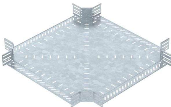
Крестообразное ответвление для создания горизонтального ответвления, фасонная деталь для защелкиваемых и привинчиваемых кабельных лотков, высота боковой стенки 85 мм. Безвинтовой монтаж с помощью двойных зажимов или резьбовое соединение посредством винтов с полукруглой низкой головкой FRS и комбинированных гаек M6. Можно устанавливать как внутри помещения, так и снаружи. Крепежный материал заказывается отдельно.
