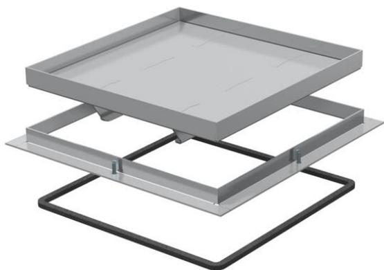
Усиленная кассетная рамка "глухая", применяется в качестве ревизионного люка. Для установки в монтажных основаниях UZD350-3 в полах с сухим или влажным типом уборки. Класс нагрузки от 2 до 20кН. Подходит только для гладких напольных покрытий во внутренних помещениях.
