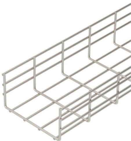
Проволочный лоток из стальной проволоки, соединенной точечной сваркой, с боковыми стенками высотой 105 мм. Размер ячеек составляет 50 x 100 мм.
