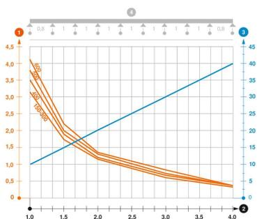
Диаграмма нагрузки на проволочный лоток типа SGR 105
