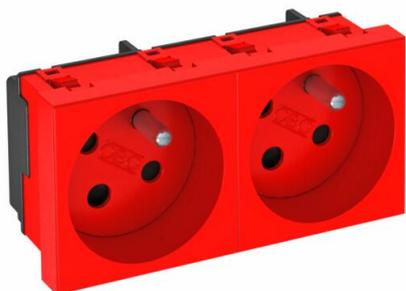
Розетка с заземляющим стержнем двойная 33°, с кодом, с защитными шторками, с автоматическими клеммами, 2-полюсная 16 А, 250 V~, автоматические клеммы соответствуют стандарту ГОСТ Р51322.1-2001 МЭК 60884-1:2006. Данная розетка может использоваться только в сочетании с кодировочным ключом типа CST-STD.
