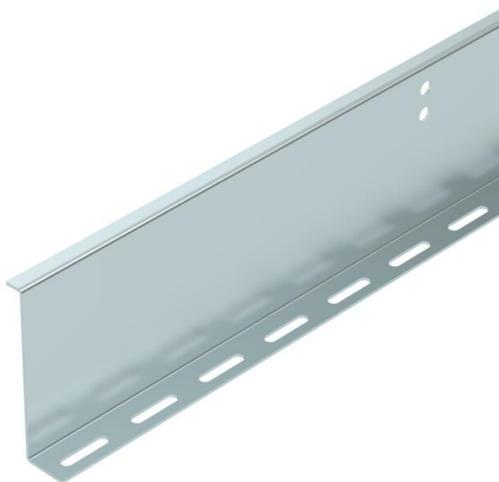
Разделительная перегородка для кабельных лотков BKRS. Крепление с плоскими круглыми болтами М 6 x 12 мм в перфорации дна. Начиная с ширины лотка 200 мм следует использовать разделительную полочку с максимальным размером отсека 220 мм.
