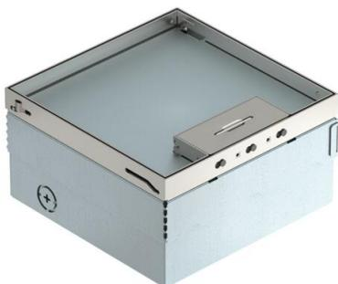
Квадратный лючок для четырех электроустановочных изделий итальянской конструкции, для установки в стяжке и в пустотном полу с сухим типом уборки в помещениях. Корпус со штампованными отверстиями для ввода труб (M25). Верхняя часть выравнивается по поверхности напольного покрытия с помощью 4-х регулируемых опор. Откидная крышка с выемкой толщиной 15 мм для фрагмента напольного покрытия. Минимальная монтажная глубина составляет 110 мм, диапазон регулирования по высоте + 30 мм.
