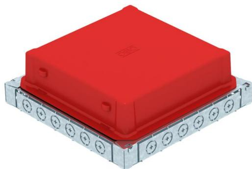
Монтажное основание для установки под полом с монтажным отверстием для лючка номинального размера 9. Монтажное отверстие изготавливается с помощью опалубки, которая входит в комплект поставки. Монтажное основание имеет отверстия для 2- или 3-секционного подпольного канала из стального листа номинального размера 25038, а также 6 электромонтажных труб M20 или M25 на всех четырех сторонах. Коробки пригодны для использования в бесшовных полах с цементной стяжкой с установочной высотой до 105 мм.
