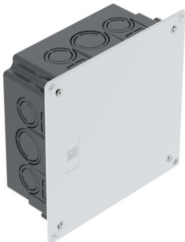
Распределительная коробка для скрытой установки для зажима клемм, применение в кирпичной кладке с глубиной монтажа не менее 65 мм. С крышкой и винтами крышки (15 мм). Плоско прилегающий край крышки, шероховатая поверхность крышки.
