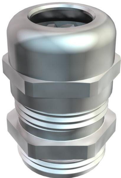
Кабельный ввод с большим диапазоном плотности, а также разгрузкой от натяжения и защитой от сильного перекручивания, с резьбой подключения Pg согласно DIN 40430, зажим из полиамида, уплотнительное кольцо из хлоропрена/нитрилового каучука, с уплотнительным кольцом, предварительно установленным на резьбе.
