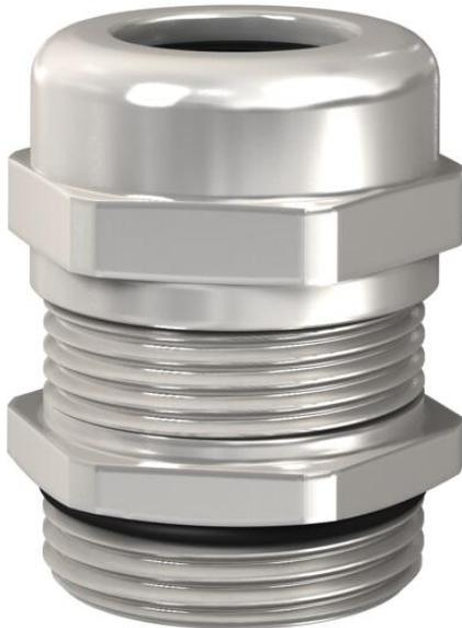
Жесткий кабельный ввод EMV с глухой гайкой с большим диапазоном плотности с метрической соединительной резьбой по IEC 423, а также разгрузкой от натяжения и защитой от прокручивания. Разгрузка от натяжения, защита от прокручивания и полная герметичность. Уплотнительное кольцо из неопрена. Зажим из полиамида. С заранее установленным О-образным уплотнительным кольцом на резьбе, проверено VDE согласно DIN EN 50262, класс защиты IP68 при давлении 5 бар в течение 1 ч.
