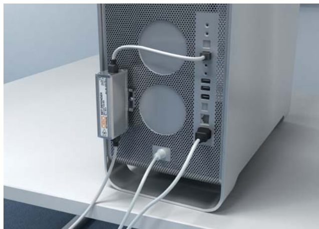
Рис. 3.82 Рекомендация по защите на оконечном устройстве.
