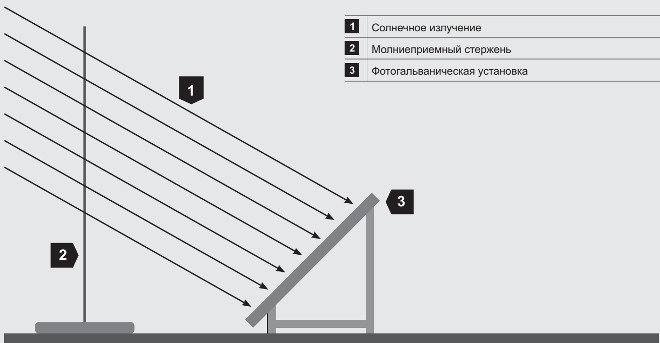
Рис. 3.22: Затенение фотогальванического модуля молниеприемным стержнем
