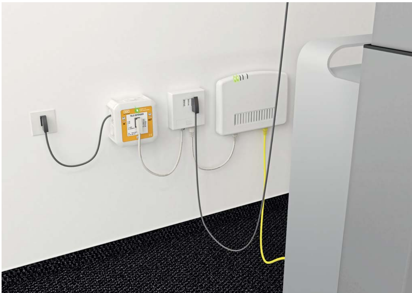
Рис. 3.69: Защита подключения ISDN + DSL при помощи TeleDefender
