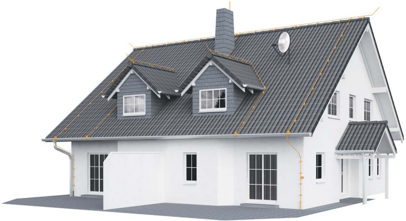
Рис. 2.41: Здание с двухскатной крышей и системой молниезащиты
