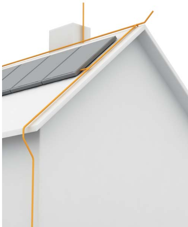
Рис. 2.19: Прямое присоединение фотогальванического монтажного каркаса к токоотводу молниезащиты
