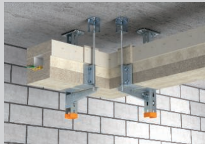
Подвесной потолочный монтаж с дополнительным креплением при помощи резьбового стержня.
