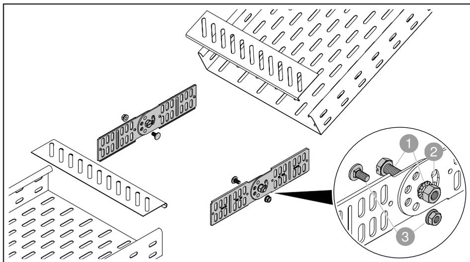
Рисунок 30: Шарнирный соединитель RGV и донные вставки
