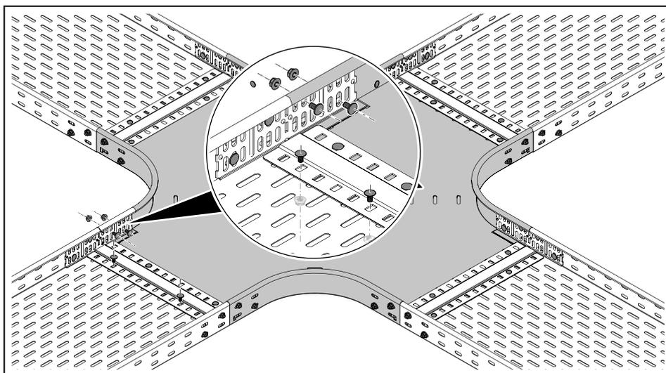
**Рисунок 60:** Монтаж крестообразного ответвления с угловыми и продольными соединителями RLVL
