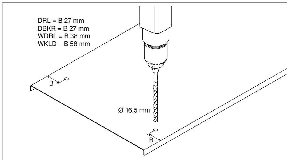
Рисунок 75: Предварительное сверление крышки
