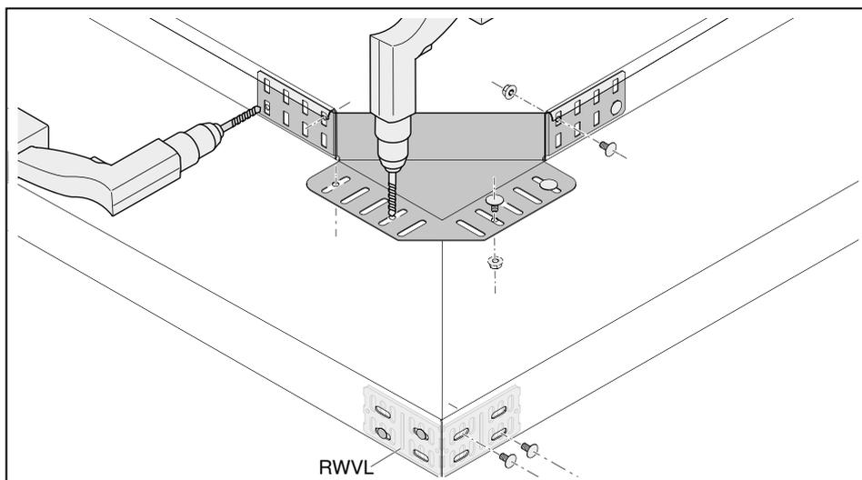
Рисунок 29: Монтаж углового соединителя REV
