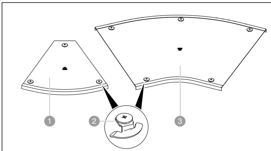
Рисунок 11: Крышки для фасонных деталей
