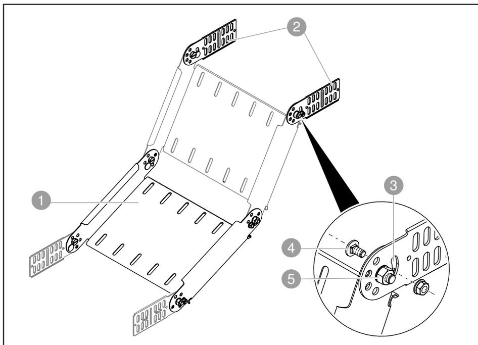
Рисунок 9: Элементы шарнирной угловой секции для смещения по высоте
