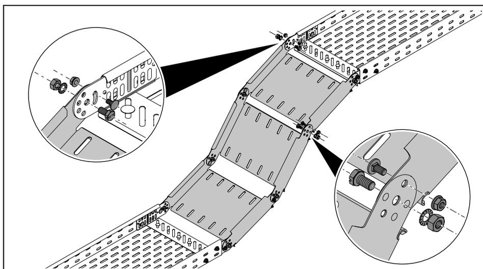
**Рисунок 64:** Монтаж элементов шарнирной угловой секции
