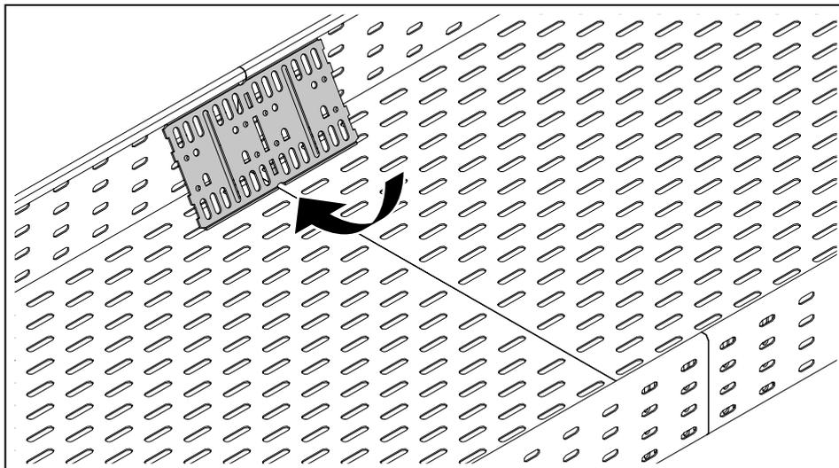
Рисунок 19: Установка продольного соединителя RLVL
