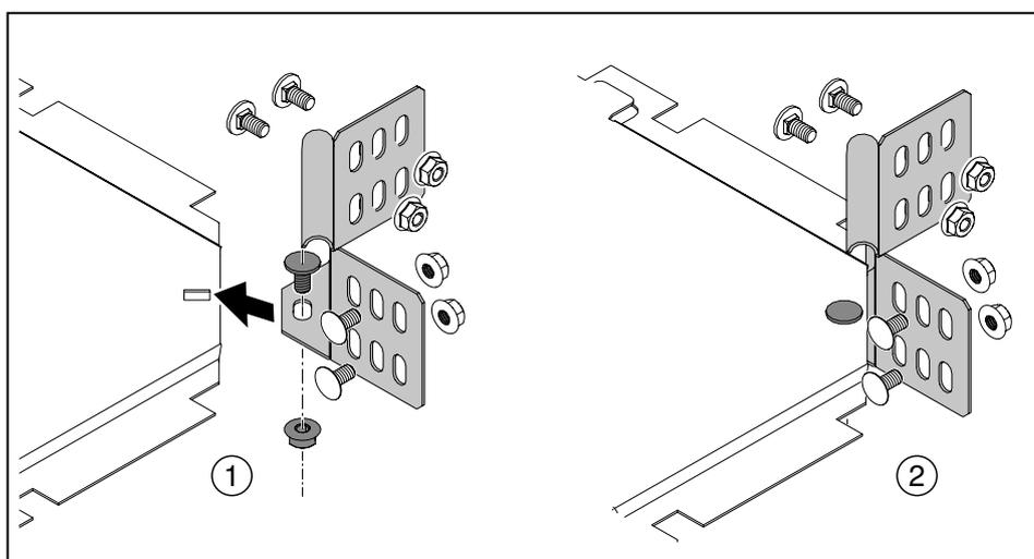
Рисунок 38: Монтаж углового соединителя WKV на фасонной детали
