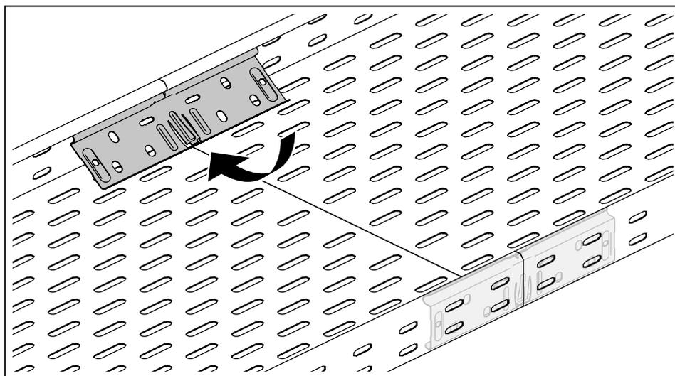
**Рисунок 15:** Установка продольного соединителя RV 607
