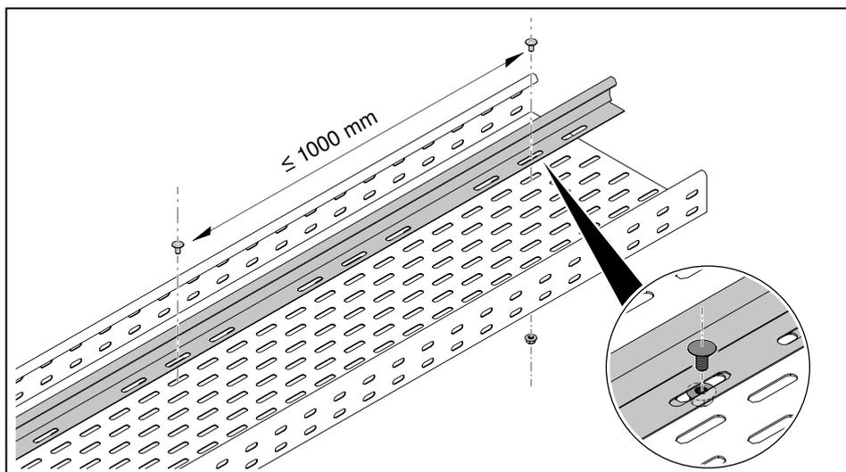
Рисунок 70: Монтаж разделительной перегородки
