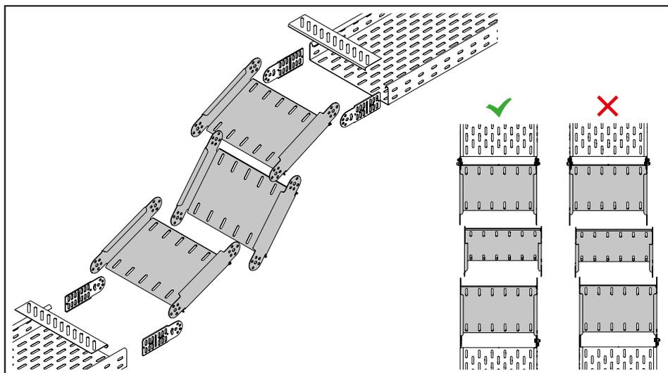
**Рисунок 61:** Элементы шарнирной угловой секции с половинными шарнирными соединителями и донными вставками
