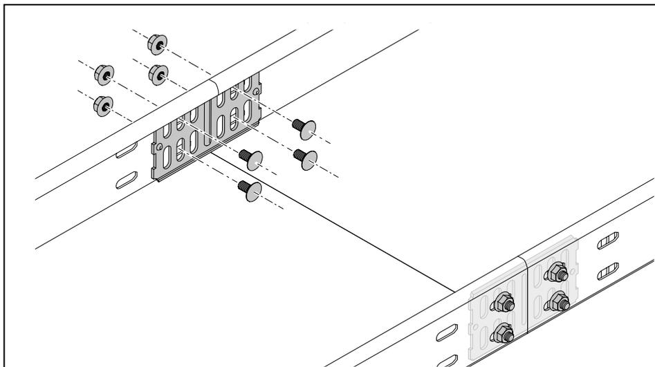
**Рисунок 18:** Прикручивание продольного соединителя RLVK
