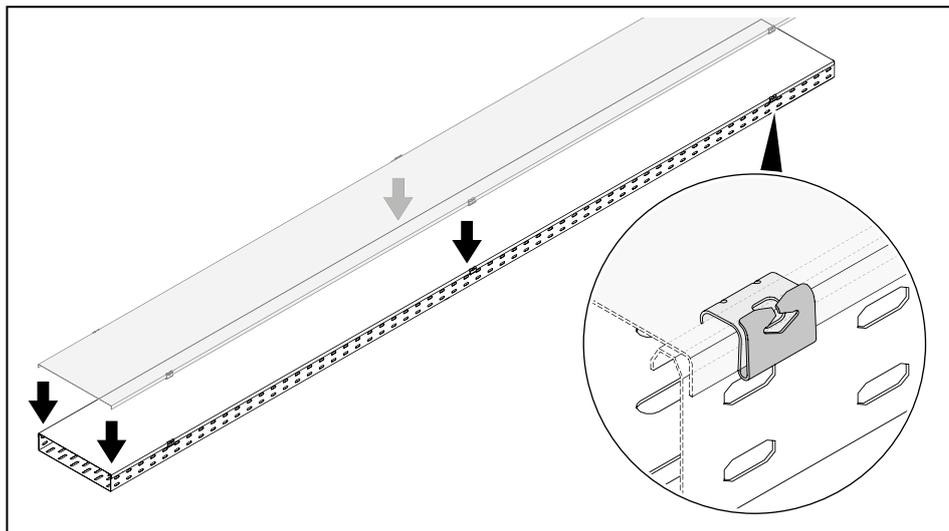
**Рисунок 74:** Защелкивание крышки
