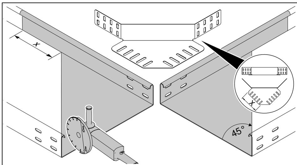
Рисунок 28: Резка кабельных лотков для углового соединителя REV
