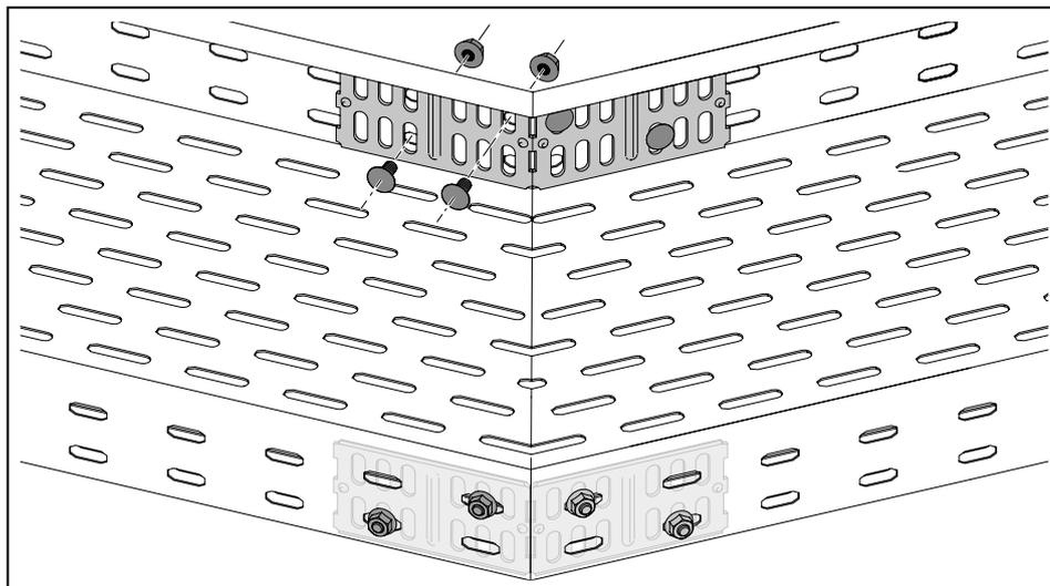
**Рисунок 25:** Прикручивание углового и продольного соединителя RWVL
