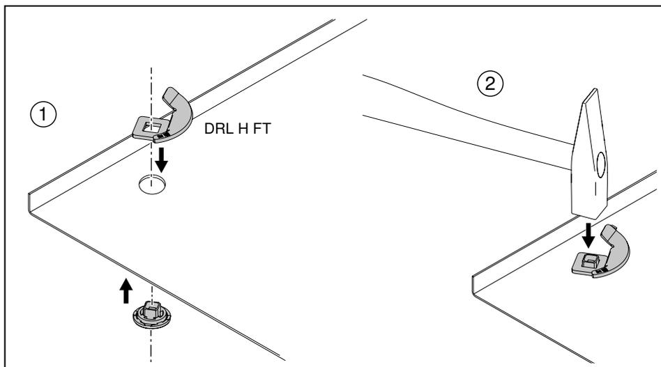
Рисунок 77: Закрепление поворотного фиксатора заклепками
