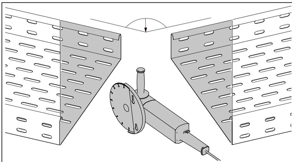
Рисунок 23: Резка кабельных лотков для создания углов
