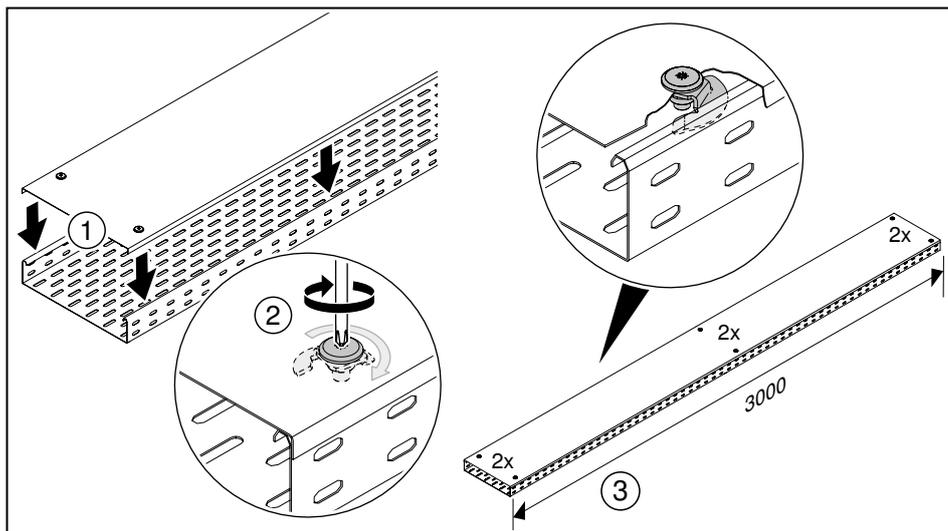
Рисунок 78: Монтаж крышки с поворотными фиксаторами Helix
