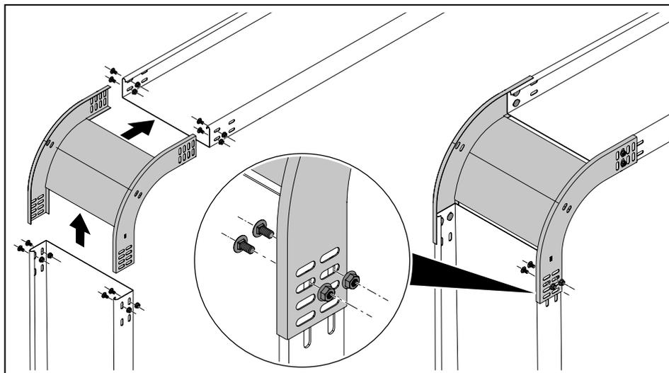
Рисунок 43: Монтаж нисходящей вертикальной угловой секции
