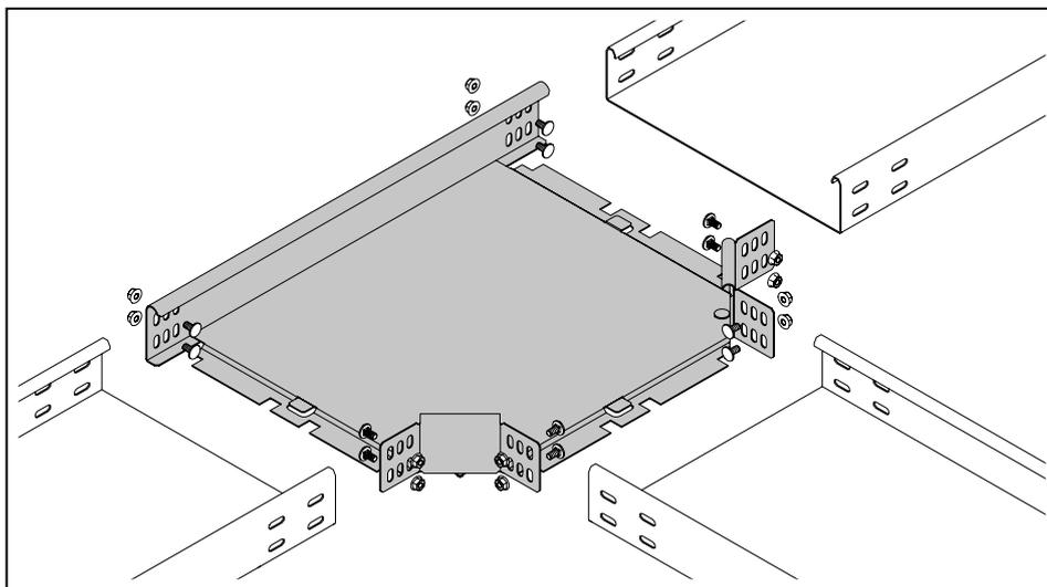
Рисунок 51: Т-образная секция с угловыми соединителями WKV
