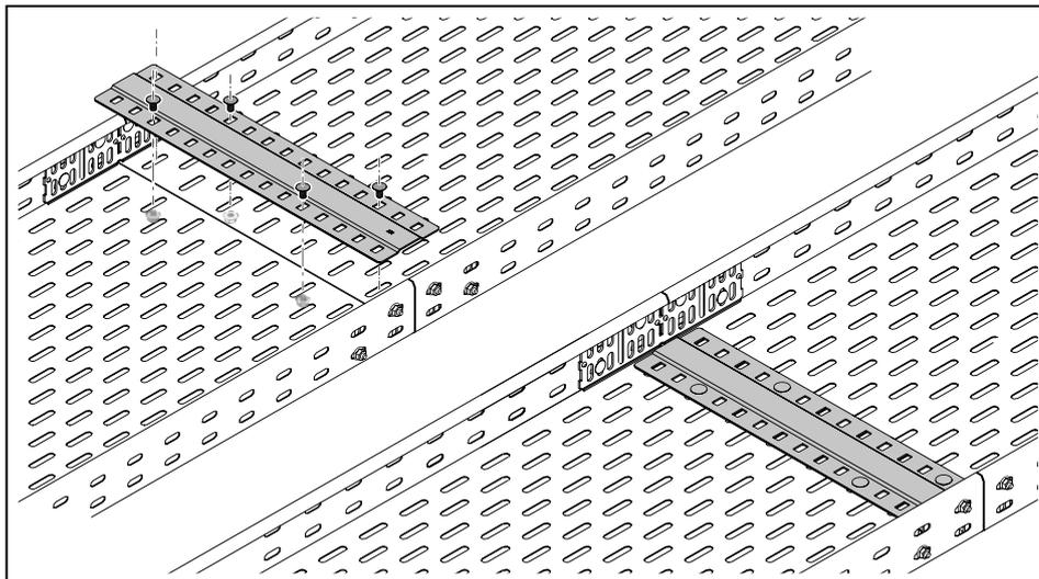
Рисунок 13: Монтаж стыковой планки
