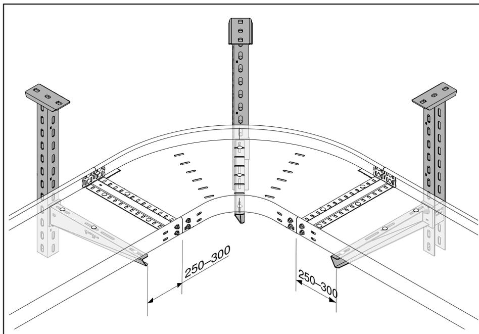
**Рисунок 36:** Пример крепления фасонной детали «Угловая секция 90°»
