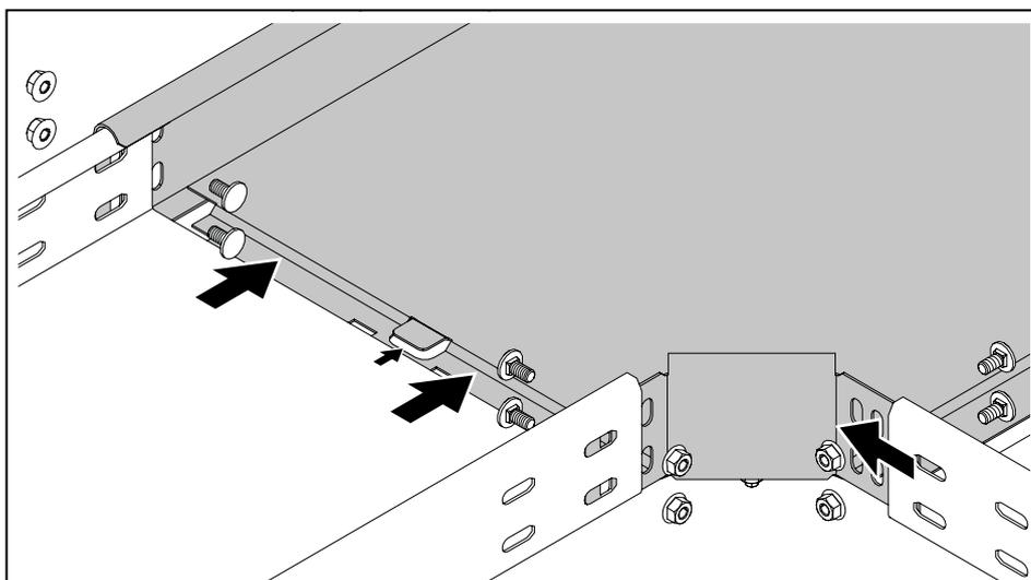
Рисунок 52: Установка кабельных лотков на Т-образную секцию
