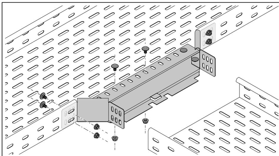
Рисунок 46: Прикручивание Т-образного/крестового соединения к сплошному кабельному лотку
