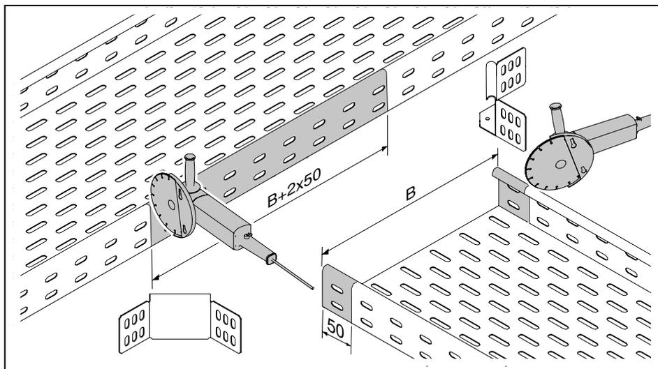
**Рисунок 26:** Выполнение выреза в боковых стенках кабельных лотков для углового соединителя WKV
