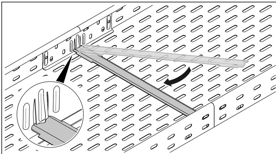
**Рисунок 16:** Установка стыковой планки
