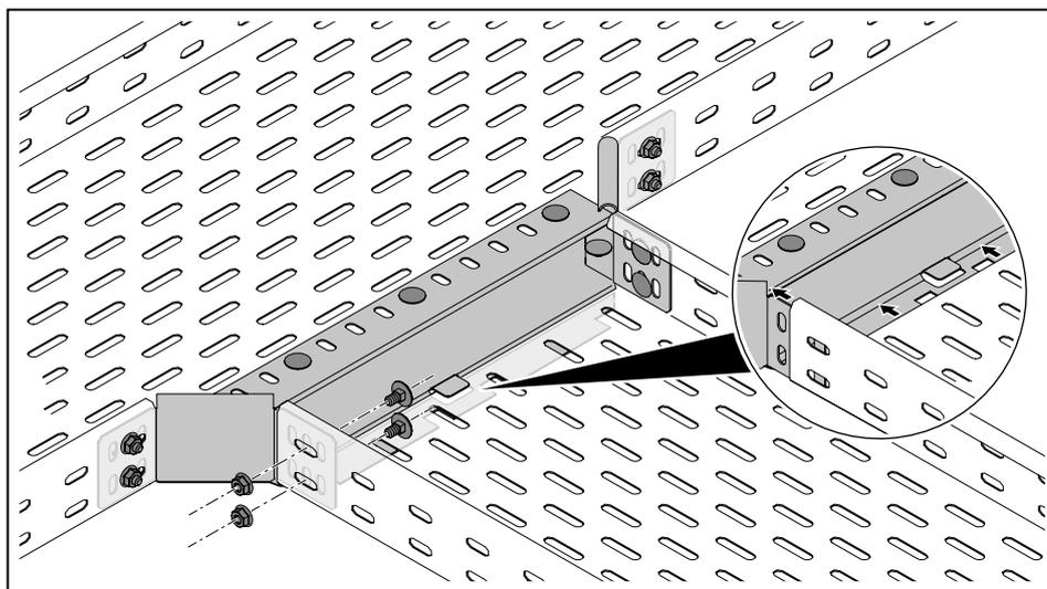
**Рисунок 47:** Прикручивание отвода кабельного лотка к Т-образному/крестовому соединению
