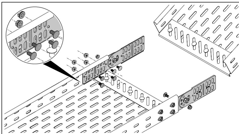
**Рисунок 32:** Прикручивание шарнирного соединителя RGV к кабельному лотку
