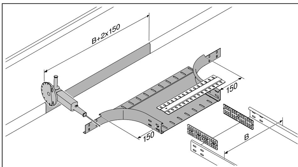
**Рисунок 48:** Выполнение выреза в боковой стенке кабельного лотка
