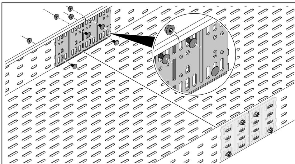
Рисунок 20: Прикручивание продольного соединителя RLVL
