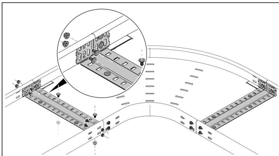
**Рисунок 42:** Прикручивание продольного соединителя и стыковых планок
