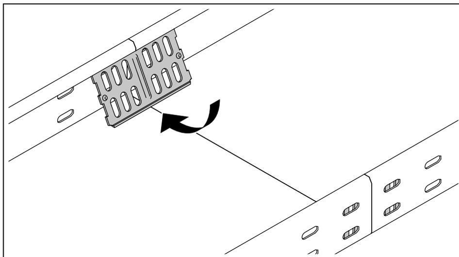
**Рисунок 17:** Установка продольного соединителя RLVK
