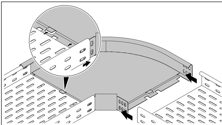
Рисунок 39: Установка угловой секции 90° на кабельный лоток
