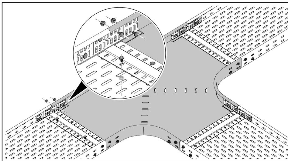
**Рисунок 55:** Монтаж Т-образной секции с угловыми и продольными соединителями RLVL
