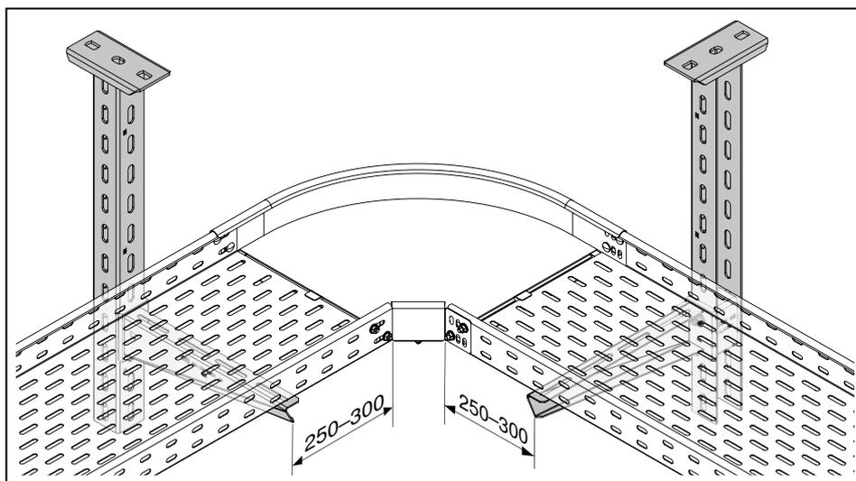
**Рисунок 35:** Пример крепления фасонной детали «Угловая секция 90°»
