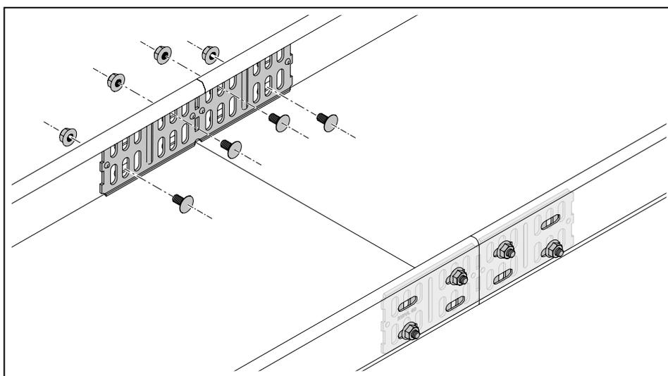
**Рисунок 22:** Прикручивание углового и продольного соединителя RWVL
