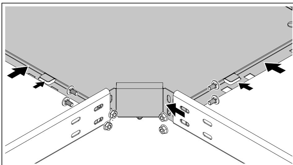
Рисунок 57: Установка кабельных лотков на крестообразное ответвление
