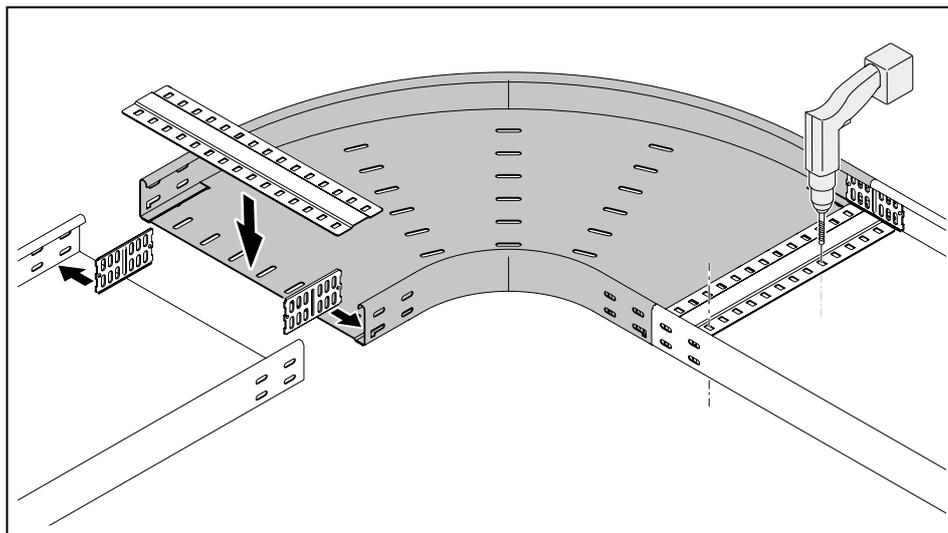
**Рисунок 41:** Предварительное просверливание монтажной перфорации для стыковой планки
