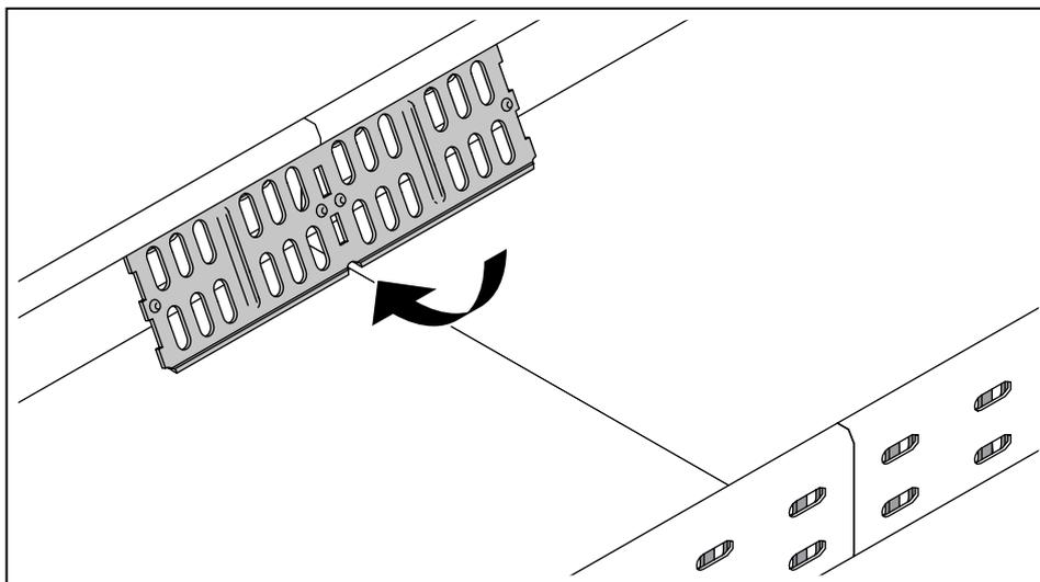
**Рисунок 21:** Установка углового и продольного соединителя RWVL
