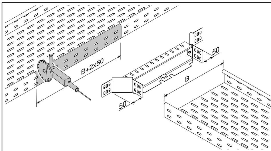
Рисунок 45: Выполнение выреза в боковой стенке кабельного лотка
