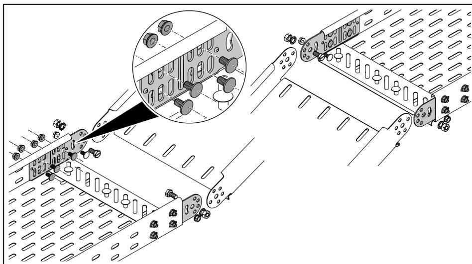
**Рисунок 63:** Монтаж шарнирного соединителя на кабельных лотках
