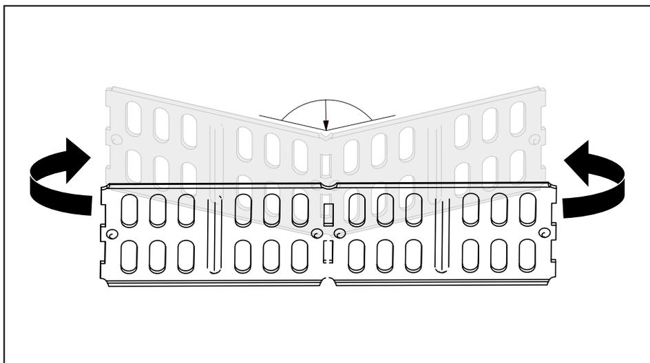
Рисунок 24: Гибка углового и продольного соединителя RWVL
