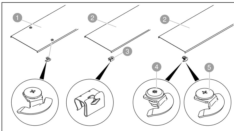
Рисунок 10: Крышки с крепежным материалом для кабельных лотков
