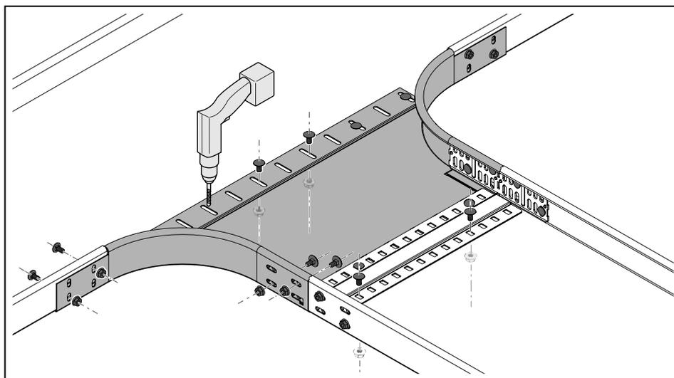
**Рисунок 50:** Монтаж Т-образного/крестового соединения на отводе кабельного лотка
