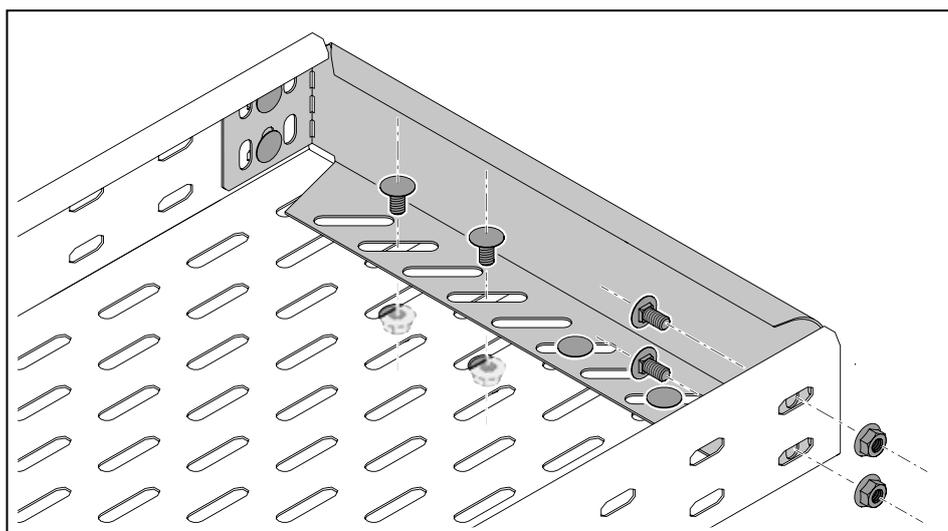
Рисунок 69: Монтаж концевика
