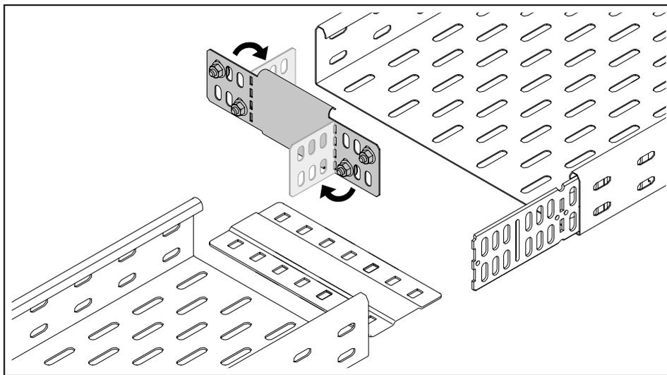
Рисунок 65: Гибка/коррекция переходника
