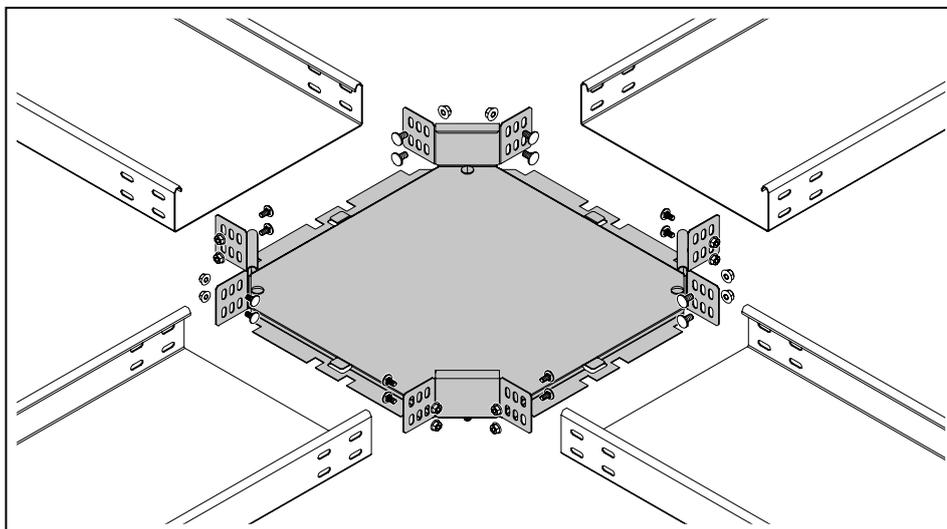
Рисунок 56: Крестообразное ответвление с угловыми соединителями WKV
