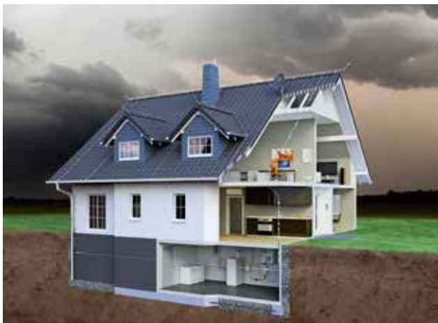
Рис. 3.22: Дом с молниеотводом и системой внутренней молниезащиты
