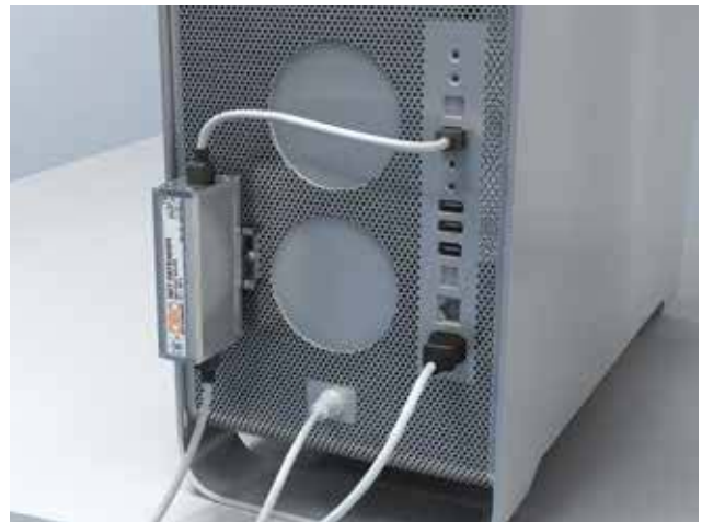
Рис. 3.82 Рекомендация по защите на оконечном устройстве.
