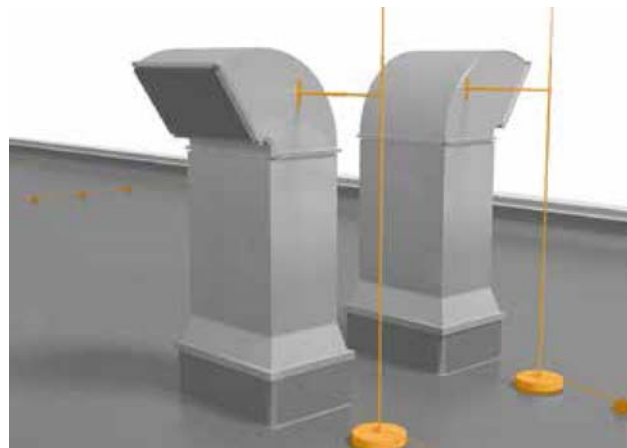
Рис. 2.31: Молниеприемный стержень с регулируемой изолированной траверсой
