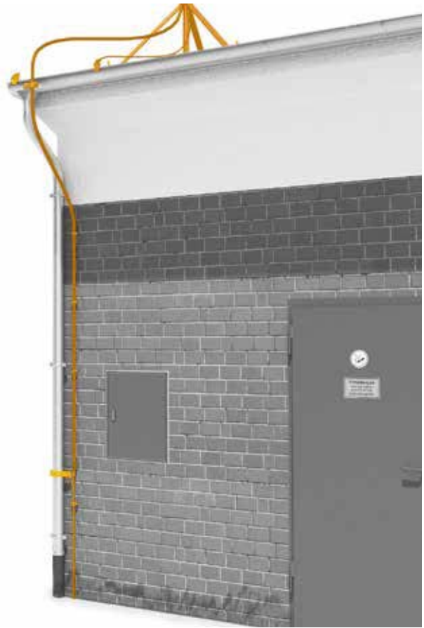
Рис. 2.56: Пример: защита газовой разводки посредством провода isCon®
