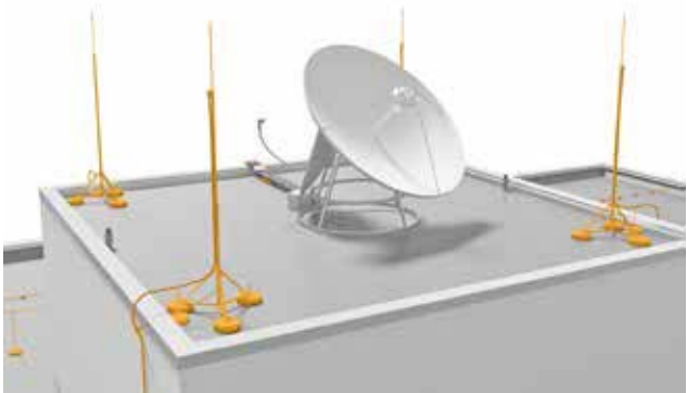
Рис. 2.61: Разделенная молниезащита с молниеприемными стержнями
