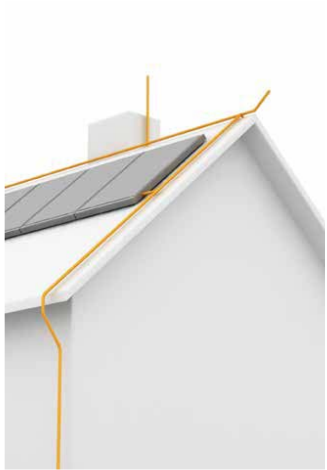
Рис. 2.19: Прямое присоединение фотогальванического монтажного каркаса на токоотводе молниезащиты
