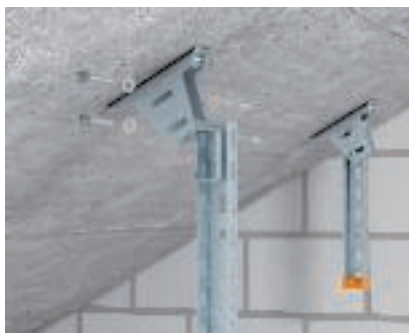
Траверса регулируемая Крепление регулируемой траверсы KU 5 V на наклонном бетонном потолке с помощью анкерных болтов и распорки DSK 47.
