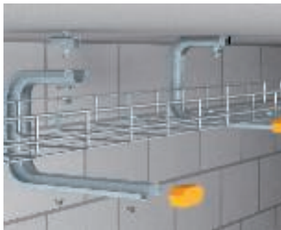
Потолочный монтаж с помощью настенной/потолочной скобы TP Потолочный монтаж проволочного лотка с помощью настенной/потолочной скобы TPDG. Крепление проволочного лотка к скобе осуществляется без применения болтов.
