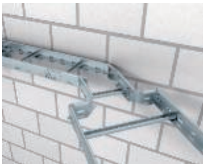
Многофункциональная секция лестничного лотка Создание уменьшения угла до 45° с помощью многофункционального соединителя типа LMFV.
