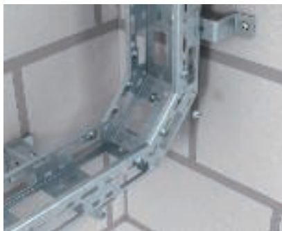
Вертикальная угловая секция 90° восходящая Монтаж восходящего вертикального угла с помощью шарнирных соединителей SV.
