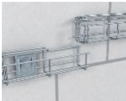
Продольное соединение G-образного проволочного лотка GR-Magic Продольное соединение G-образных проволочных лотков путем установки секций лотка друг в друга.
